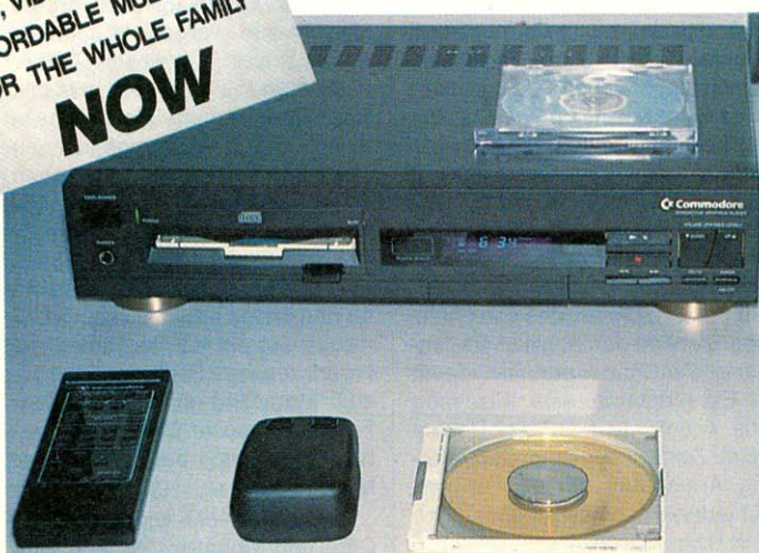
CDTV Im Grunde handelt es sich um einen Amiga 500 mit CD-ROM und einer Infrarot-Fernsteuerung
