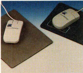
Die optische Maus (links) arbeitet ohne Rollkugel
